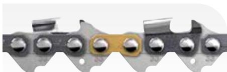
Halbmeißelkette (0.325"/1,3 mm). Als Allrounder für große Holzmassen. Die schmale Schnittbreite in Kombination mit den Eigenschaften unserer X-CUT. Sie gewinnen dadurch an Schnelligkeit und Effizienz. Insbesondere für Motorsägen bis zu 55 cm<sup>3</sup> Leistung. Der Rückschlag wird dank der Sicherheitsglieder minimiert.
