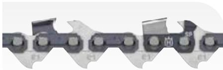
Die SP21G ist eine Halbmeißelkette (0.325" Mini/1,1 mm) die den Rückschlag minimiert. Die innovative Kombination aus optimaler Schnittgeschwindigkeit und der effizienten Kettenteilung sorgt für einen gleichmäßig glatten Schnitt, einen hervorragenden Einstechschnitt sowie eine verbesserte Handhabung und Manövrierbarkeit – wichtige Merkmale bei der Baumpflege. Passend für die .325" mini X-PRECISION-Schienen.
