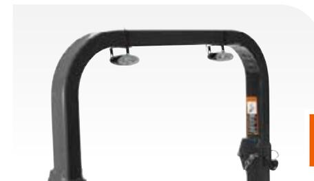
Ein am Überrollbügel befestigter Beleuchtungssatz, bestehend aus doppelten 35W-Halogencheinwerfern, die einfach angeklemt werden. Zum bequemen Bedienen über den Zündschalter wird die Halterung an den vormontierten Zubehörsstecker angeschlossen.
