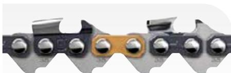
Halbmeißelkette (0.325"/1,5 mm). Erweitertes Sortiment im Bereich .325 Teilung. Eine Allrounder-Kette, die mit einer breiteren Schnittbreite für Motorsägen bis zu 55 cm<sup>3</sup> Leistung geeignet ist. Dank den Sicherheitstreibgliedern wird der Rückschlag minimiert. Teil der Erstausrüstung von Husqvarna 550 XP® Motorsägen.
