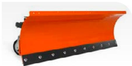
Robustes Stahl-Schneeräumschild mit hydraulischer Winkelverstellung und einer Arbeitsbreite von 135 cm. Erfordert Hydraulikkit und Heckgewicht. Das Schneeräumschild muss entweder mit Gleitkufen und Stahlleiste oder mit Stützrädern und Gummileiste kombiniert werden.
