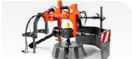
Zapfwellenbetriebene Wildkrautbürste zum gründlichen Entfernen von Unkraut und Schmutz aus Rinnen, von Gehwegen und an Bordsteinen. Der Bürstenwinkel ist vom Fahrersitz aus einstellbar. Durchmesser 50 cm. Erfordert Hydrauliksatz und Heckgewicht.
