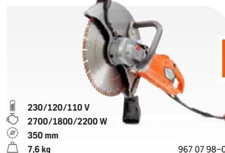
Dieser elektrische Allround-Trennschneider minimiert die Wasser-, Staub- und Schlammabildung. Anders als bei anderen Elektro-Trennschleifern dreht sich die Trennscheibe vorwärts, was effizient Trennschneidarbeiten bei geringer Belastung des Bedieners ermöglicht. Die K 4000 lässt sich mit der optionalen Vakuumeinheit leicht zu einem Trockenschneider mit minimaler Staubabildung umbauen.
