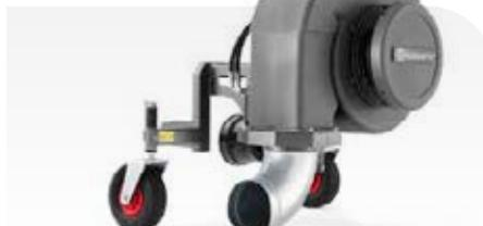
Zapfwellenbetriebenes Bläsergerät zum Säubern von großen, offenen Flächen. Kraftvolles, geräuscharmes Gebläse mit einem Luftstrom von 80 m<sup>3</sup>/min. Vom Fahrersitz aus verstellbarer, 360 Grad Luftauslass. Erfordert Hydraulikkit.
