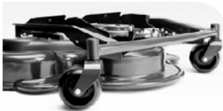
Husqvarna Combi Decks kombinieren das sehr effiziente BioClip™-Mulchen mit dem Heckauswurf. Die robuste Konstruktion ist aus einem Stück gestanzt, was dank des optimierten Luftstroms zu seiner hohen Effizienz beiträgt. Wählen Sie zwischen Mähbreiten von 112 cm, 122 cm und 103 cm. Die Mähdecks der X-Modelle sind mit elektrischer Höheneinstellung ausgestattet. Muss mit einem Steckdosensatz kombiniert werden.
