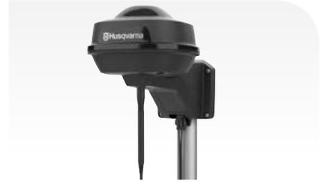
Dieses Gerät verrechnet die RTK-GNSS-Signale zwischen den Husqvarna EPOS™-Mährobotern und den Navigationssatelliten. Jede Station ist für zahlreiche Mäher geeignet. Arbeitsbereich bis zu einem Radius von 500 m. Um größere Bereiche abzudecken, können mehrere Referenzstationen in einem Netzwerk betrieben werden.
